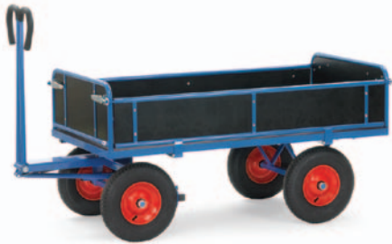
Variante 2 mit Bordwänden (wasserfestes Sperrholz) 250/325 mm hoch, 3 Seiten abklappbar, Stirnwand feststehend
