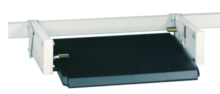
SO-860 Fussstütze mit Gasfeder Höhe 90-260 mm, Neigungswinkel 5-30°
