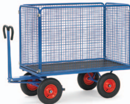
Variante 4 mit Drahtgitterwänden 40 x 40 x 4 mm, 1000 mm hoch, Stirnwände verschraubt, Längswände einhängbar und herausnehmbar.
