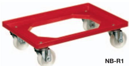
Châssis en plastique, charge utile 250 kg, 4 roulettes pivotantes en polyamide Ø 100 mm
