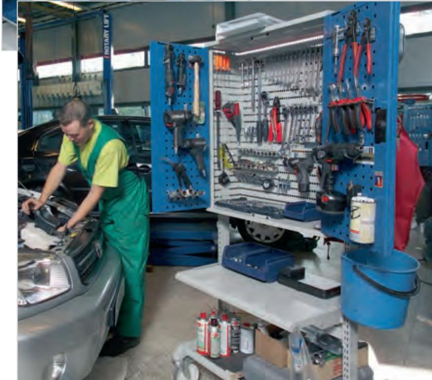
Stahlböden, Aufhängeleisten, Lochplattenrückwände, Wandlochplatten und ein Lochplattenschrank können an den Raster-Profilleisten befestigt werden.
