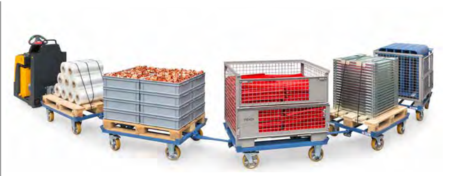
Routenzug mit Elektroschlepper und 5 Paletten-Fahrgestellen
