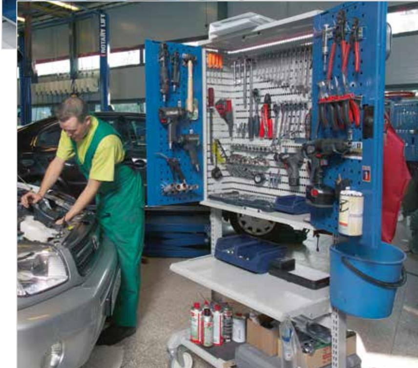
Des tablettes en acier, des traverses, des parois et panneaux arrières perforés et une armoire à panneaux perforés peuvent être montés sur des profils verticaux.
