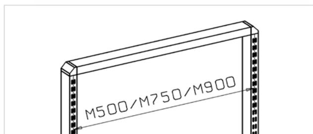
La dimension modulaire (M) se rapporte à la distance entre deux montants verticaux à partir du centre de ceux-ci. Cette dimension permet de choisir des accessoires adaptés.
