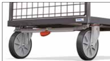
TOTALSTOP – Le système de blocage centralisé fetra Une simple pression du pied suffit à bloquer à la fois la rotation et le déplacement des roues. La pédale restant toujours visible. De série sur nos chariots fermés ESD.
