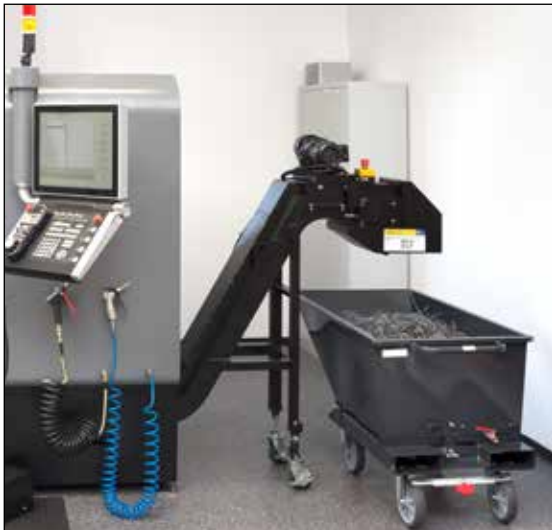
Anwendungsbeispiel: Muldenkipper als Spänebehälter
